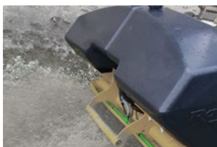
Option pressure watering 2 water tanks of 150L 12V or 24V plugs / Druckbewässerung (12V-Pumpen-Kit - erfordert Stromversorgung) - 2 Wassertanks mit 150 Litern mit automatischer / Aspersor a presión - 2 depósitos de 150 L (kit de bomba 12 V - requiere alimentación eléctrica)
