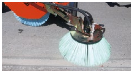
Side brush Ø 700 with rotation reverser Seitenbesen Ø 700 mm mit 3-Wege Ventil Cepillo lateral Ø 700 con válvula de inversión de 3 vías
