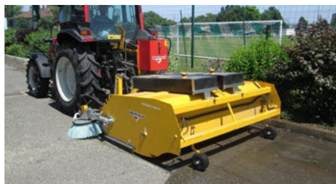
TURBONET 2000 A with watering mit Optionen Sprühvorrichtung, Hydraulikaggregat und Seitenbesen con opción de aspersor + unidad hidráulica
