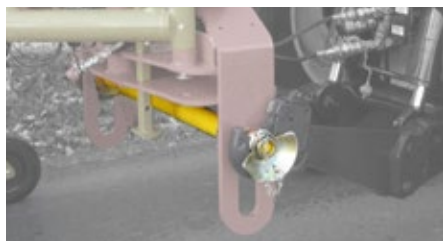
Linkage n°3 with swinging drawbar Automatische Kupplungsstange Kat. 3 Enganche con barra n°3
