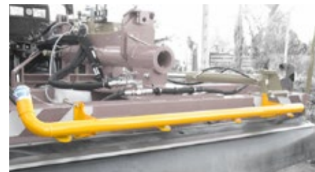
High pressure watering line, 4 sprayers Sprühleiste mit 4 Düsen - hohe Wasserleistung Riego gran caudal con rampa 4 chorros y conexión de bomberos
