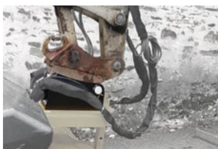
Quick fit coupling for excavator Adaptation on all type of carrier and coupling on the market / Schnellwechsler für Bagger Anpassung für alle Träger und Schnellwechsler / Se adapta a todos los portaequipajes y accesorios del mercado
