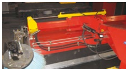
Hydraulic angling by a cylinder and hydraulic offset by motor Hydraulische Ausrichtung und Seitenversatz Orientación hidráulica y compensación por cilindro
